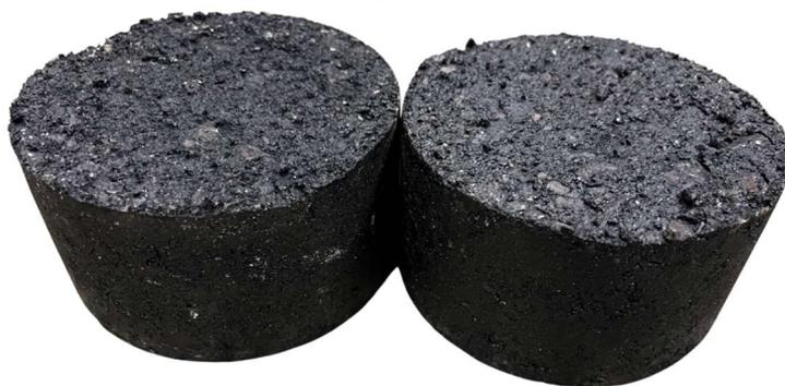
**Figura 3.20 - Corpo de prova com ruptura por cisalhamento fora da interface das camadas asfálticas**
