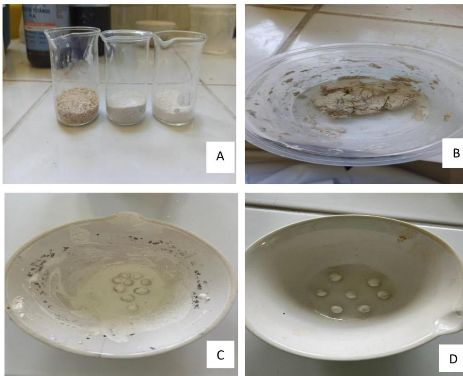
Nota: A: materiais principais utilizados na mistura; B: massa sendo homogeneizada; C: preparação da pasta de dióxido de titânio; D: esferas prontas para ir à mufla.
