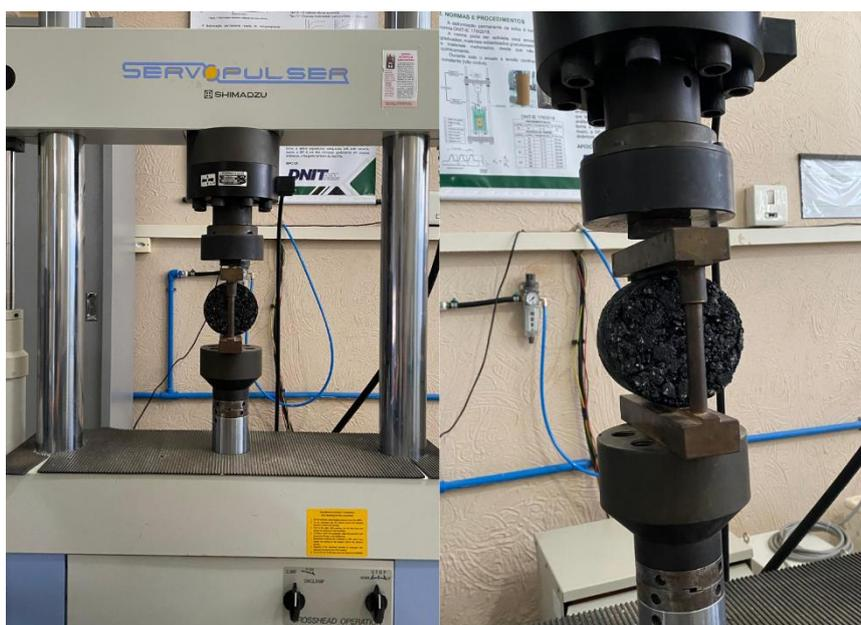
Para garantir resultados confiáveis, a norma recomenda que sejam testados três corpos de prova para cada tipo de mistura. A média dos valores obtidos nesses ensaios é usada para determinar a resistência à tração da mistura asfáltica avaliada.
