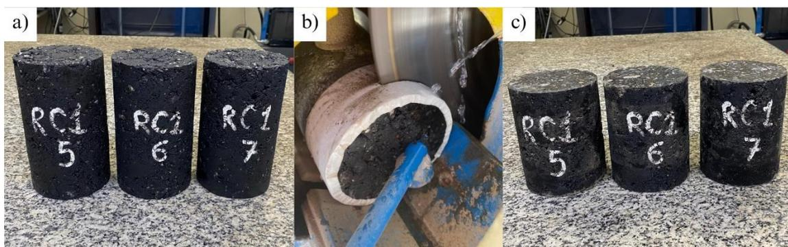
Após o corte, os corpos de prova foram fixados nas placas superior e inferior (*endplates*) usando adesivo epóxi de baixa fluidez, com cura de 24 horas. Um gabarito foi utilizado para garantir o alinhamento correto das amostras, essencial para evitar tensões excêntricas. O processo está ilustrado na Figura 41.
