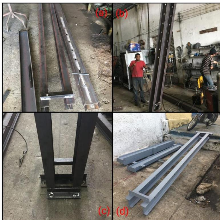
A montagem dos perfis resultou em um pórtico composto por quatro pilares, sendo dois deles em cada lateral da caixa de concreto do modelo. Sobre o centro geométrico da caixa passam duas vigas, uma localizada no topo da estrutura, fixada por quatro parafusos que tem como principal função o travamento da estrutura metálica e outra denominada viga de reação.
