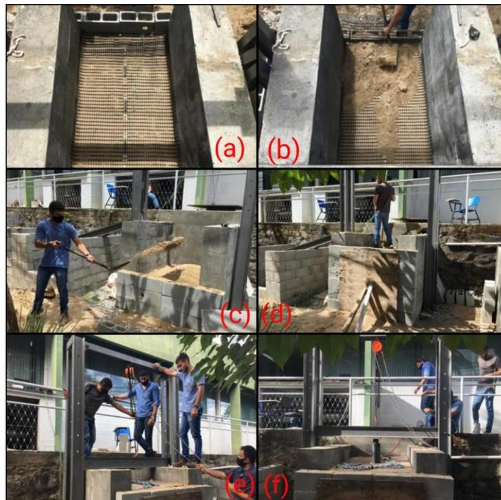
Nas Figura 46 (b) e (c) é possível visualizar a diferença no lançamento do material no nível imediatamente em contato com os sensores e a geogrelha e em um nível onde os sensores já estavam envoltos por uma camada de solo e não havia contato direto entre o material lançado
