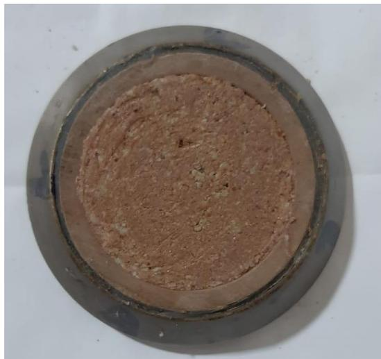
Após moldagem, as amostras foram transferidas para o anel de adensamento e, posteriormente, para a célula do edômetro, onde são medidas as variações da espessura em função do tempo até a estabilização (Figura 47).
