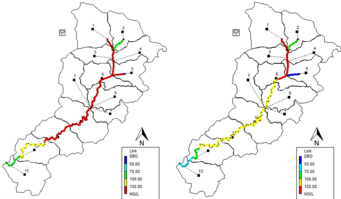
A retirada das contribuições de esgoto resulta em mudanças nos trechos a jusante. A Figura 38 mostra a variação da concentração de DBO ao longo da simulação nos trechos 6, 7 e 8 antes e depois das retiradas E, F e G. Em relação à concentração de DBO houve uma redução de 10% no trecho 6, 15% no trecho 7 e de 25% no trecho 8. Já nas concentrações de DQO e FT não houve redução significativa nos trechos analisados.
