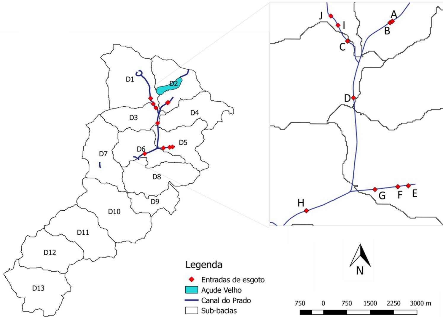
Figura 13 – Identificação dos pontos de entrada de esgoto no Canal do Prado
