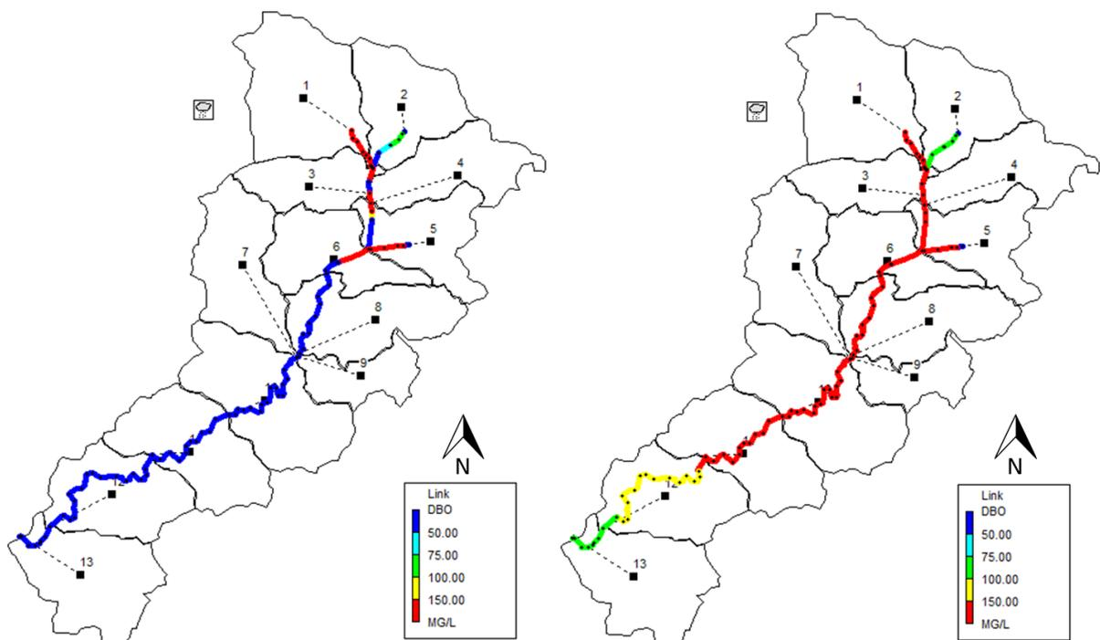
O trecho 1 corresponde à parte do canal com menor concentração de DBO, com valores de 44 a 93 mg/L. Essa baixa concentração é explicada porque o fluxo, oriundo do extravasamento do açude, não apresenta características típicas de esgoto. Os pontos de maior potencial poluidor se encontram no trecho 4, que apresenta coloração vermelha já nos primeiros 15 minutos simulados, com valores variando entre 353 e 576 mg/L, e média de 469 mg/L, valor associado a esgoto médio, segundo Pessoa e Jordão (2011).
