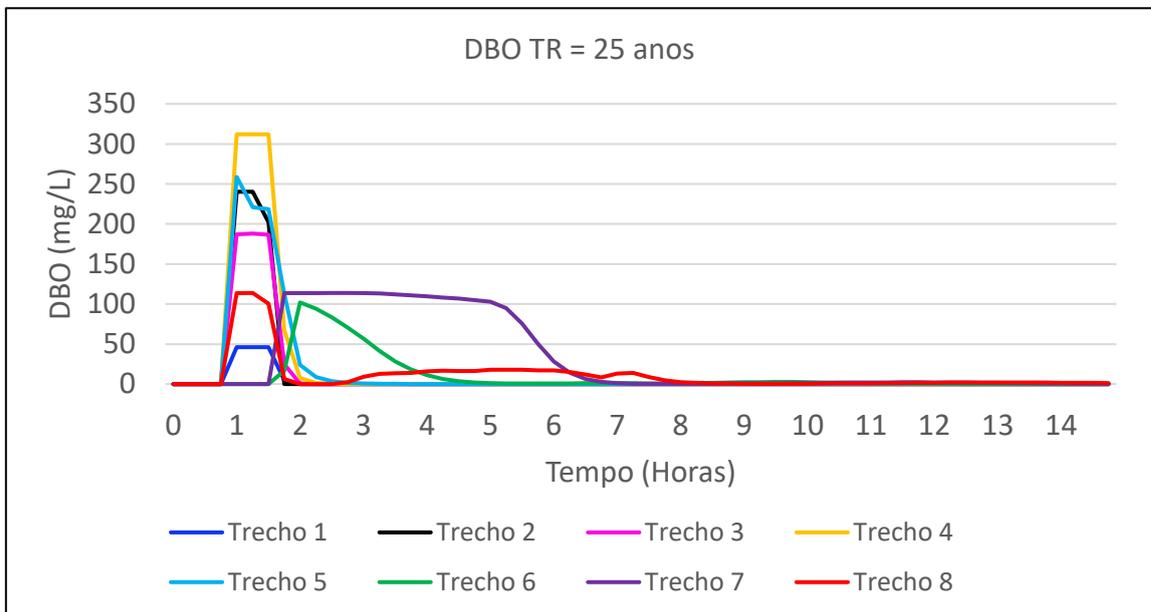
Observando o comportamento da concentração do poluente ao longo do tempo, percebe-se que ocorre uma estabilização do valor da DBO no evento de 10,6 mm em todos os trechos, não ocorrendo redução na concentração durante as 15 horas do evento simulado. Após uma hora, ou seja, às 16 horas de simulação, a concentração dos poluentes começa a diminuir.
