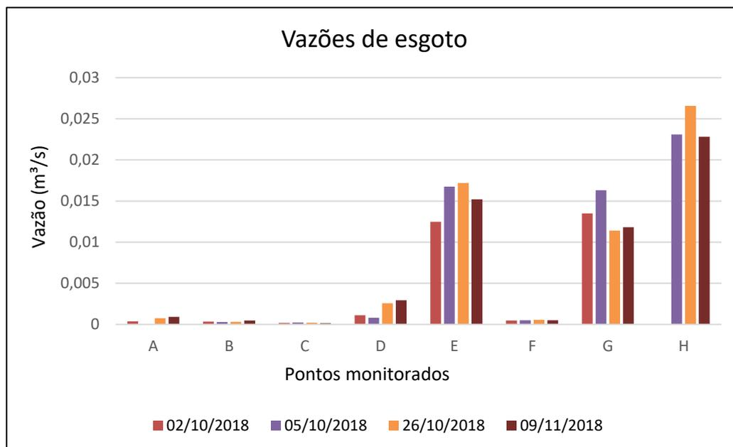
Após análise, verificou-se um comportamento relativamente estável em todos os pontos monitorados no mesmo horário, assim, o valor adotado como a vazão de esgoto em cada ponto foi a média das quatro medições realizadas. A Tabela 18 apresenta os valores médios obtidos.
