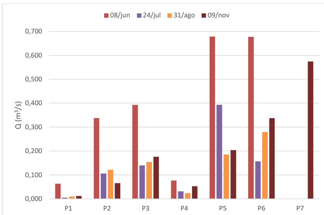
Observaram-se maiores valores de vazão específica em todas as seções analisadas na primeira medição em consequência dos altos valores de vazão registrados nesse dia causados pela chuva ocorrida antes e durante a medição. Os maiores valores de vazão específica no período chuvoso são encontrados no ponto P2.
