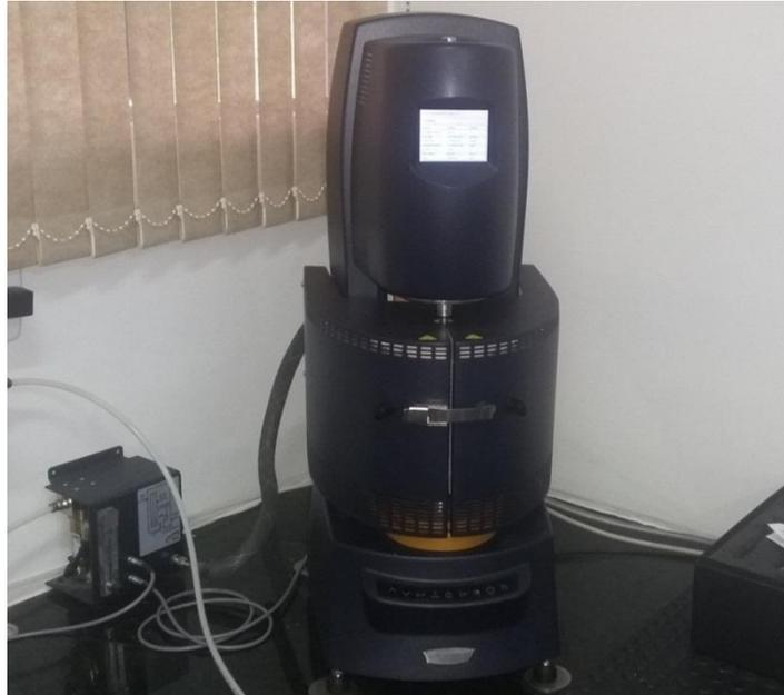
O reômetro de cisalhamento dinâmico (*dynamical shear rheometer* – DSR) é utilizado na metodologia de dosagem SUPERPAVE para caracterização das propriedades viscoelásticas do CAP a temperaturas elevadas e intermediárias (BRINGEL, 2007).
