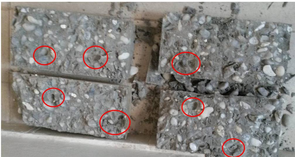
Figura 4.18 – Identificação de alguns vazios nos corpos-de-prova moldados com seixo rolado e rompidos a 3 dias.
