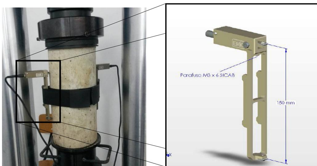
Figura 3.14 – Extensômetro Eletrônico Emic modelo EEDA.
