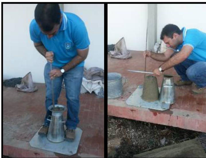
Figura 3.9 – Ensaio de abatimento de tronco de cone realizado no laboratório de solos e concreto do 3º BEC.
