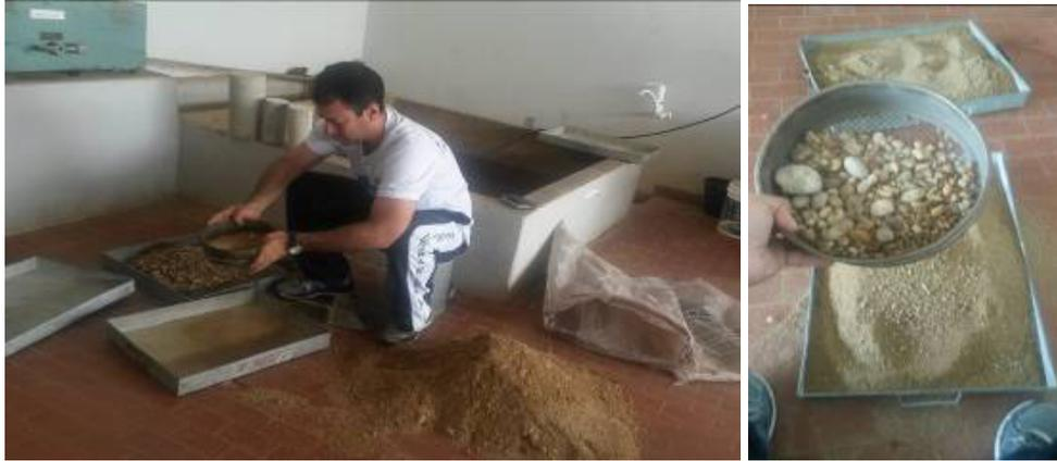
Figura 3.1 – Peneiramento do agregado miúdo.
