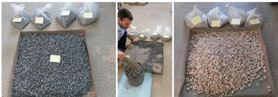
Figura 4.9 – Determinação da mistura ideal dos agregados graúdos.
