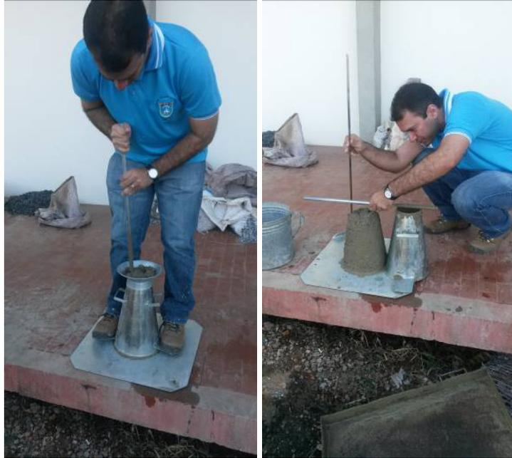
Figura 4.13 – Ensaio de abatimento de tronco de cone (*Slump Test*).
