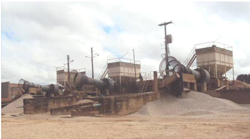
Figura 2.3 – Detalhe um centro de lavagem e peneiramento do massará/seixo em Teresina – PI.
