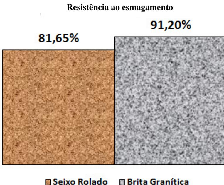
Figura 4.6 – Resistência ao esmagamento dos agregados graúdos utilizados na pesquisa.
