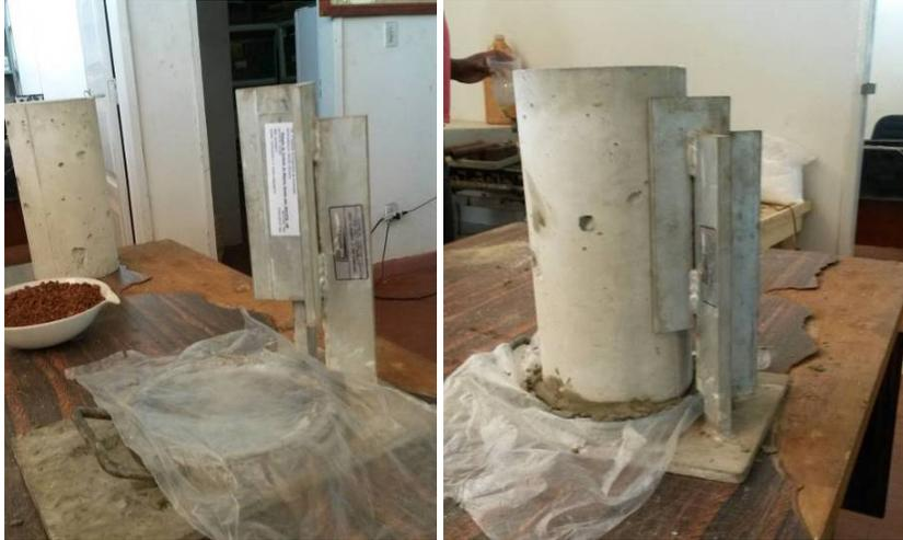
Figura 4.14 – Capeamento dos corpos de prova.
