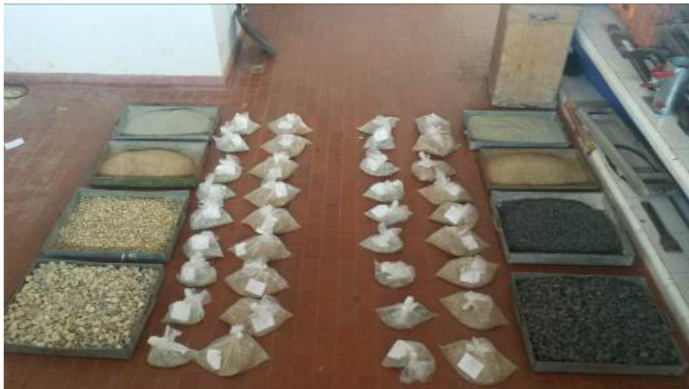
Figura 3.6 – Arranjo das materiais para determinação do teor de argamassa do traço experimental 1:5,0 com seixo rolado e com brita granítica.
