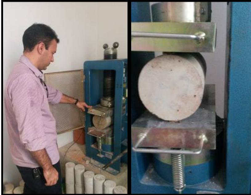
Figura 3.12 – Ensaio de resistência à tração por compressão diametral realizado no laboratório da BM Engenharia.
