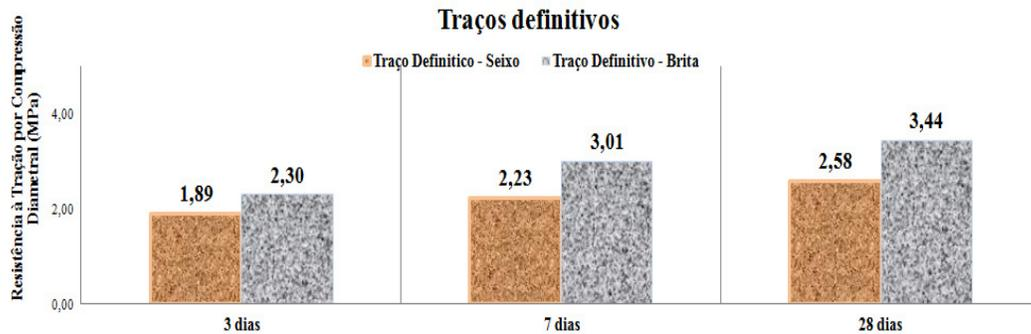
Figura 4.16 – Resultados dos ensaios de resistência à tração por compressão diametral.
