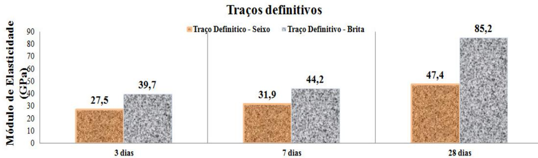
Figura 4.19 – Resultados dos ensaios de módulo de elasticidade – Ec.
