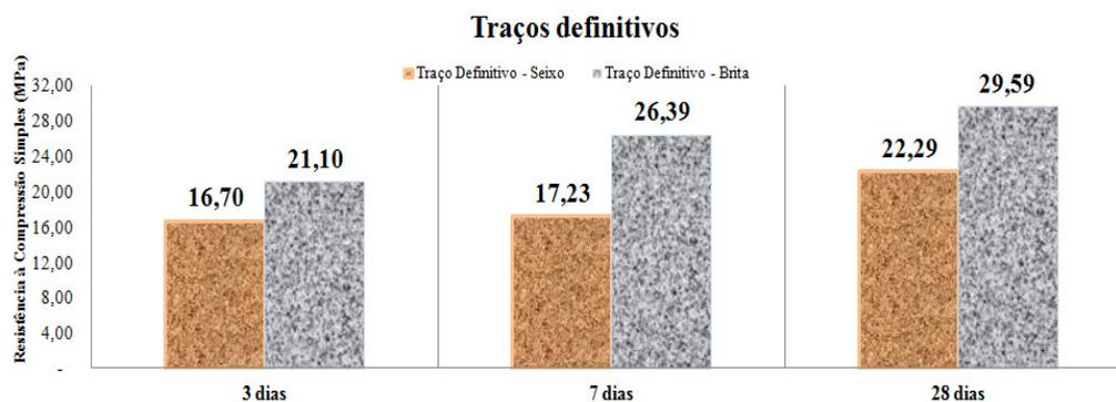
Figura 4.15 – Resultados dos ensaios de resistência à compressão simples - fcc.
