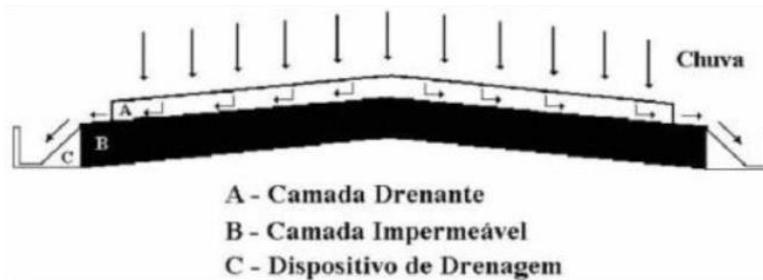
É importante perceber a diferença entre os sistemas de infiltração dos pavimentos da Figura 4 e da Figura 3. Neste, a água infiltra através da superfície (revestimento) e percola todas as camadas inferiores do pavimento e, dependendo do sistema de infiltração, permite ou não a percolação da água através do subleito. A estrutura de pavimento permeável da Figura 3 é mais indicada à ruas, avenidas, pátios e estacionamentos.
