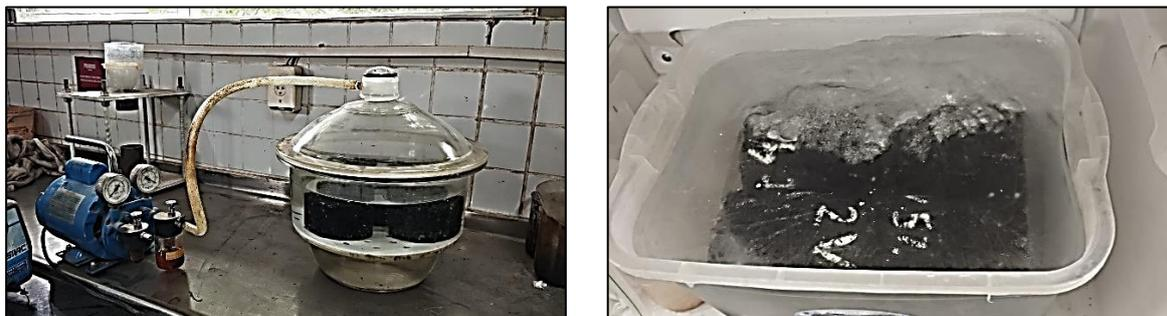
Nesta pesquisa, seguiu-se o que a Norma DNIT 180/2018-ME e a NBR 15617/2015 preveem para as misturas convencionais, ou seja, um ciclo de condicionamento para o primeiro conjunto de corpos de prova. O dano por umidade induzida é definido como a razão entre a resistência à tração por compressão diametral dos corpos de prova condicionados ( $RT_c$ ) e não condicionados ( $RT$ ), denominada relação de resistência à tração retida (RRT) definida pela Equação 11.
