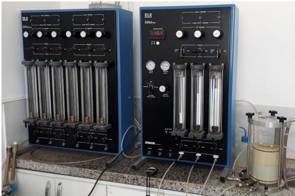
Calculou-se o coeficiente de permeabilidade à água por meio do Método A – Carga constante, D5084 (ASTM, 2016a), aplicada para permeabilidade de amostras saturadas segundo a Equação 2.
