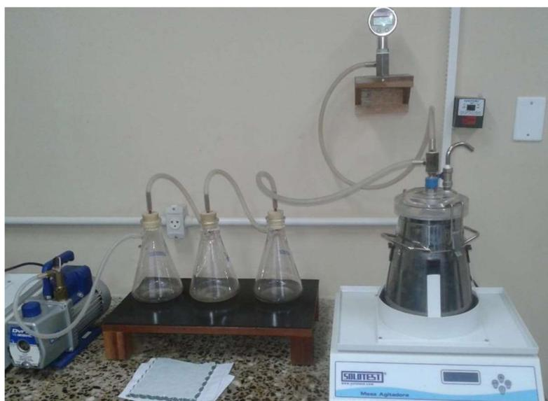
Com os corpos de prova pesado secos e submersos e de posse dos seus diâmetros e altura média é possível determinar os valores de  $V_v$  (volume de vazios),  $VAM$  (vazios no agregado mineral) e  $G_{mm}$  (massa específica máxima) e assim escolher a curva a ser
