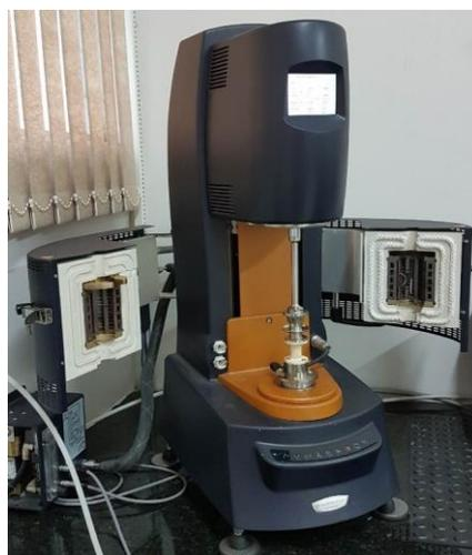
A reologia do ligante asfáltico da presente pesquisa foi realizado por meio dos ensaios de PG (Performance Grade), MSCR (Multiple Stress Creep Recovery), Curva Mestre e LAS (Linear Amplitude Sweep). O programa de ensaios para os ligantes asfálticos está apresentado no fluxograma 2.
