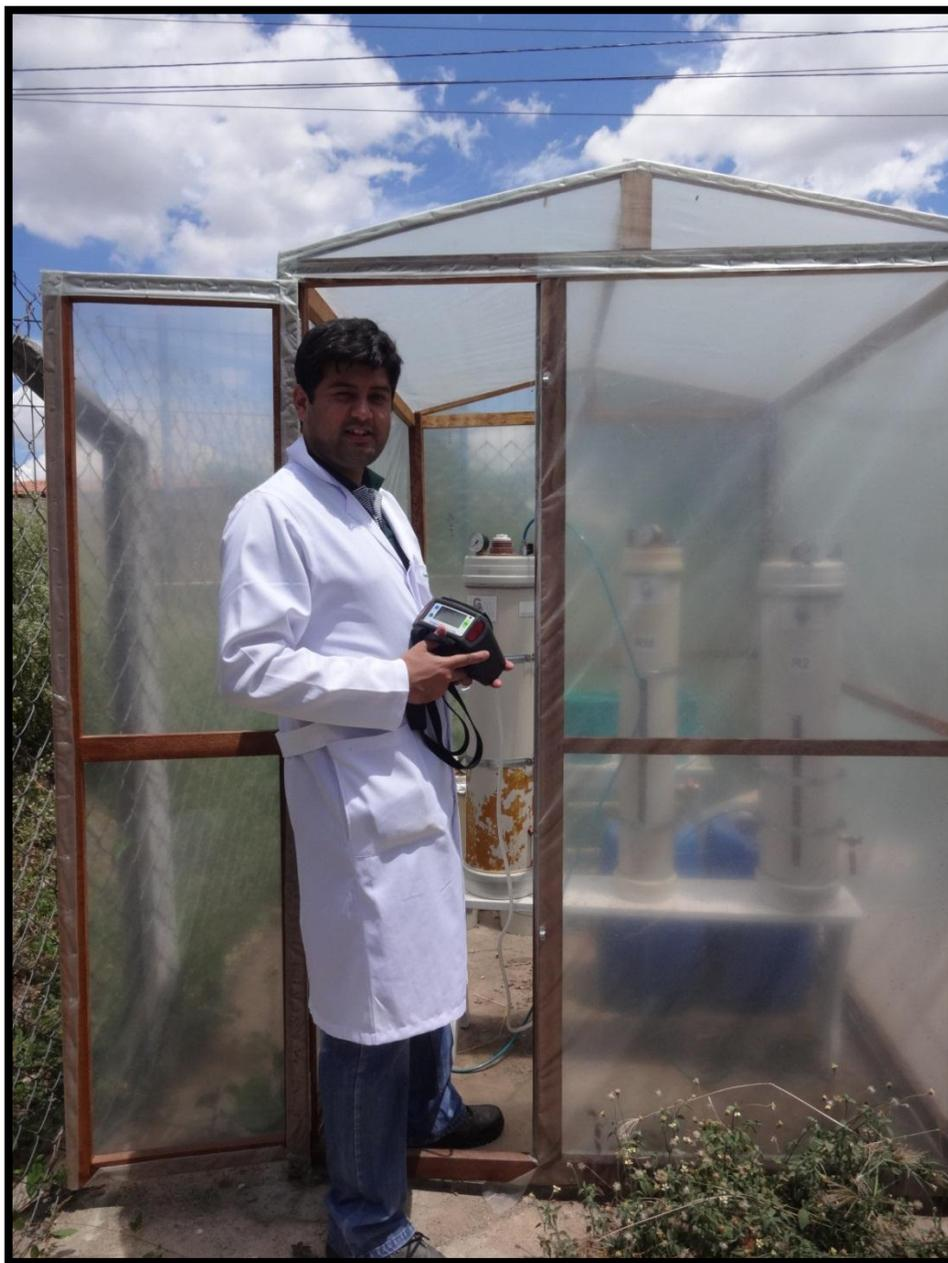
O resultado das concentrações obtido pelo método do drager é em torno de 5 minutos, ou até a estabilização das leituras, com as faixas de medição de acordo com o Quadro 7, para esse tipo de equipamento, o que torna as análises viáveis pela praticidade, rapidez e pela margem de erro que é de apenas 5%, além de possibilitar medições *in situ*. É considerado na leitura das concentrações para os gases CH<sub>4</sub>, CO<sub>2</sub>, H<sub>2</sub>S e CO o maior percentual acusado no equipamento.
